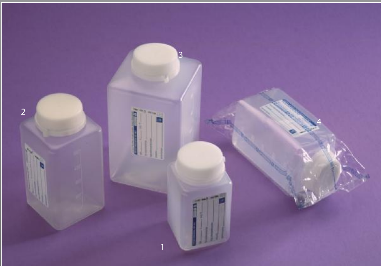
Бутыли для проб воды полипропиленовые полупрозрачные стерильные с градуировкой, крышка с контролем вскрытия
